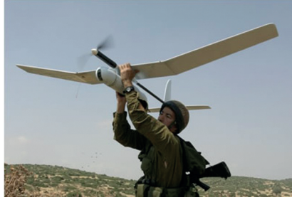
17. kép: Skylark (Paesirta) rövid hatótávolságú, harcászati pilóta nélküli repülőgép Forrás: www.army-technology.com/projects/skylark-ii/
