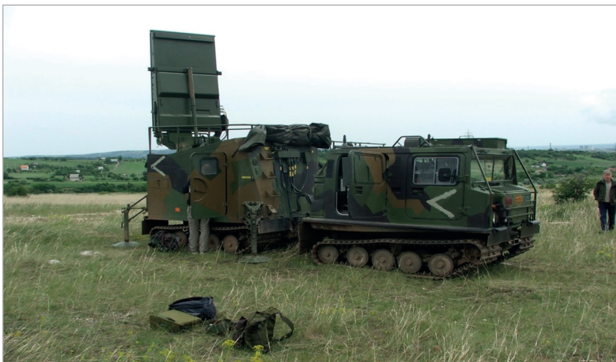
15. kép: Arthur tűzszköz-felderítő lokátor Forrás: https://en.wikipedia.org/wiki/ARTHUR_(radar)
