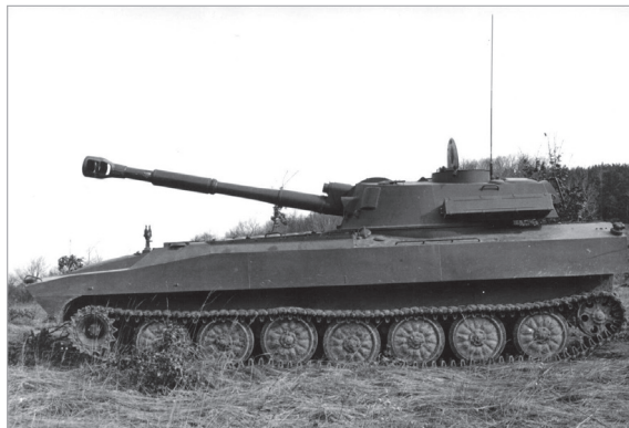
7. kép: 122 mm-es önjáró tarack, „GVOZGYIKA”
