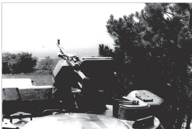
12. kép: IV14 harcjármű a kombinált parancsnoki figyelőműszerrel képes éjszakai körülmények között is a célfelderítésre és a tűzfigyelésre
