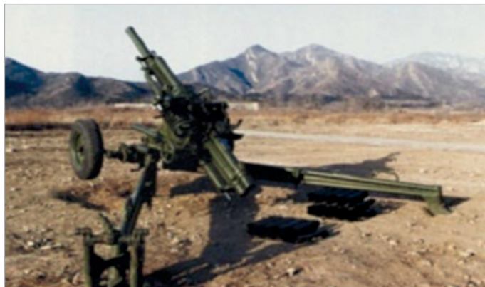
1. kép: 82 mm-es automata aknavető
