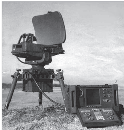
10. kép: Az ellenséges harckocsik és páncélozott harcjárművek felderítésére és megjelenítésére hivatott RADAC felderítő lokátorállomás
