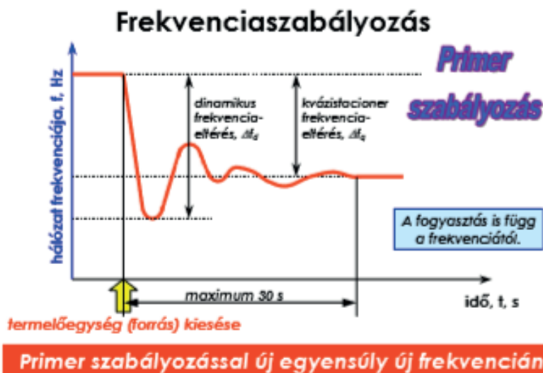
6. ábra: Az erőművi primer (frekvencia) szabályozás elve
