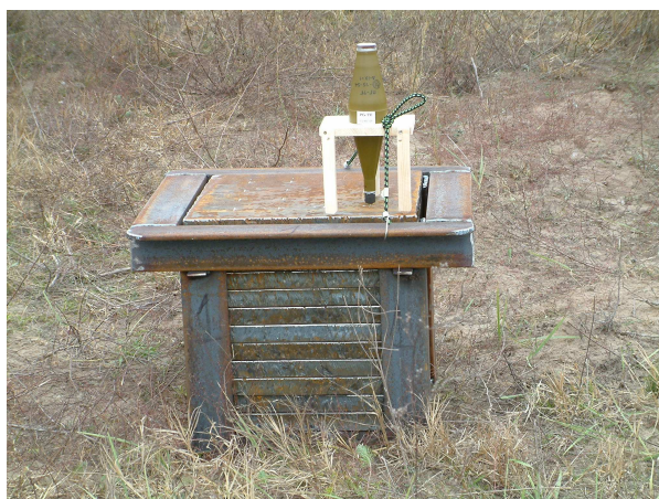
I.2.-4. ábra. A robbantás gyakorlati elrendezése
