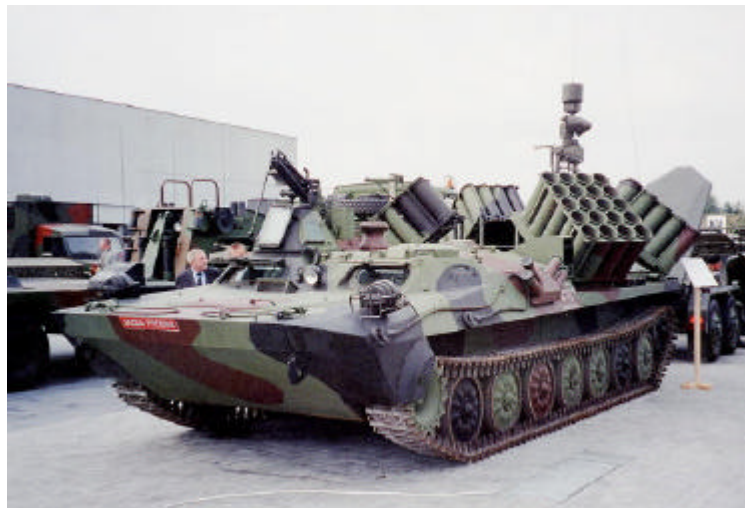
17. számú ábra: Aknaszóró berendezés MTLB–U lánctalpas járművön 98
