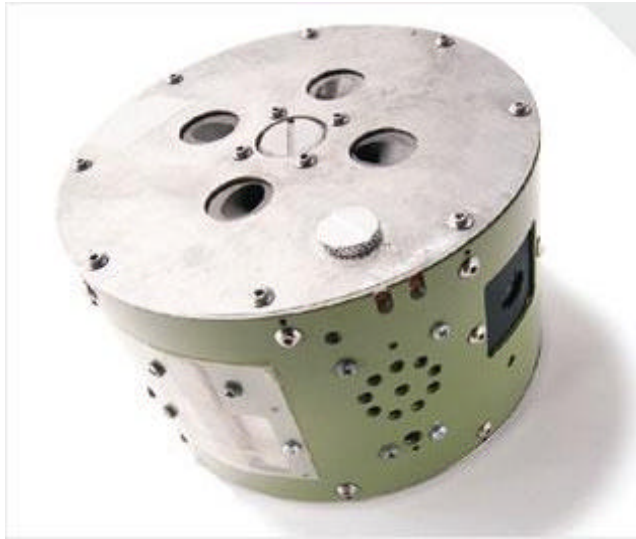
29. számú ábra: Önhelyreállító aknamezőben alkalmazott akna (SHM) 150
