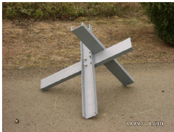
52. számú ábra: Összeszerelhető fémsündisznó 192
