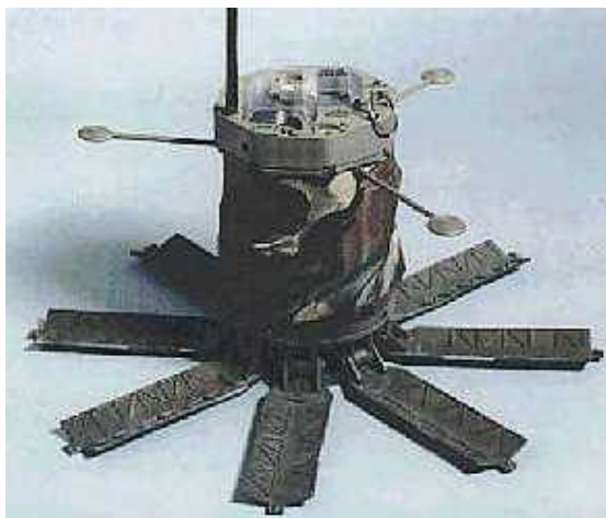
9. számú ábra: Torony elleni akna telepített helyzetben (M93 HORNET) 73
