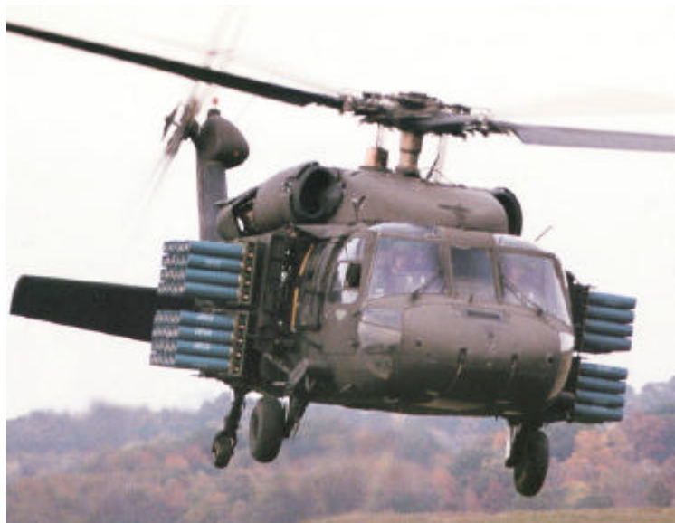
19. számú ábra: Aknaszóró berendezés helikopterre szerelve (AIR VOLCANO) 101
