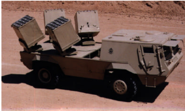
49. számú ábra: Aknaszóró berendezés páncélozott kerekes gépjárművön (Fahd APC) 188
