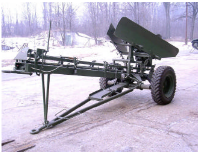
51. számú ábra: MLG-60 típusú vontatott aknatelepítő 191
